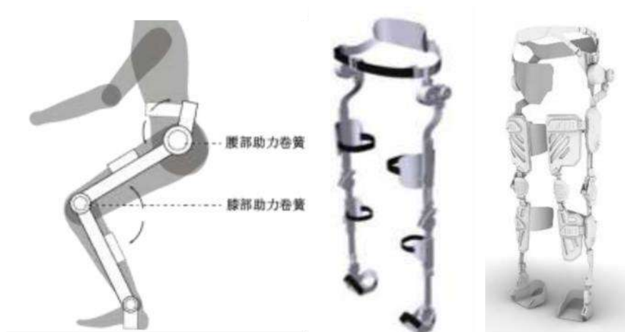
图3 消防下肢外骨骼助力方式、结构及其设计渲染图
